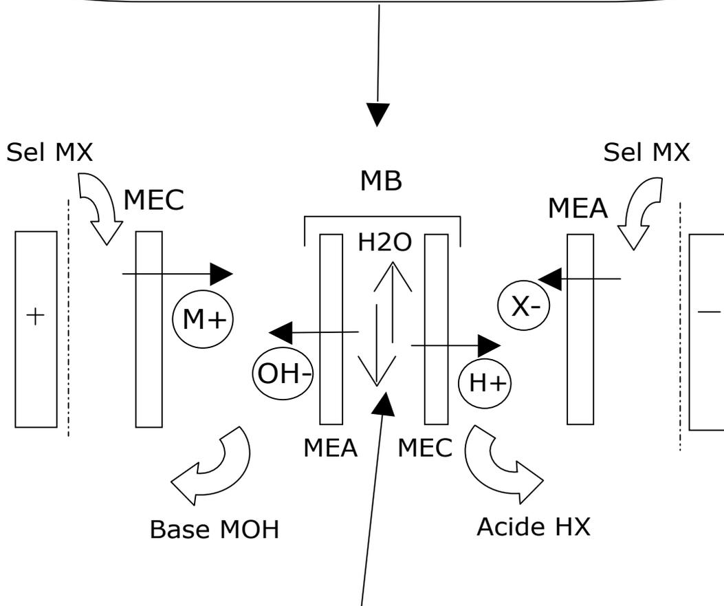
Sous l'effet du champ électrique, l'eau qui imprègne la membrane MB est dissociée; il y a génération de protons et d'ions hydroxydes, ce qui permet les recompositions d'acide et de base dans les compartiments adjacents.
