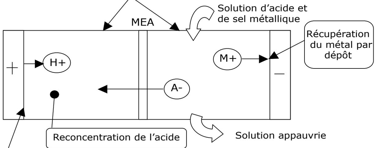
L'électrolyse de l'eau est utilisée pour la production soit de protons, soit d'ions hydroxydes (ici de protons)
